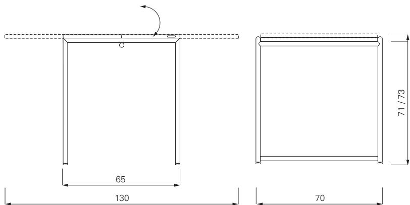
Ausklappbarer Tisch. Gestell aus verchromtem Stahlrohr. Tischplatte mit weißem Melamin beschichtet, massiver Buchenumleimer. Details siehe Preisliste.
